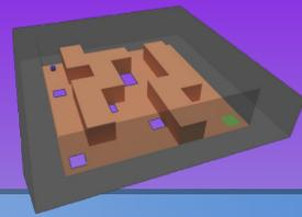
Pour détecter la présence de la bille à l'arrivée, nous allons donc mettre un plan qui sert déclencheur lors de sa collision avec la bille.
